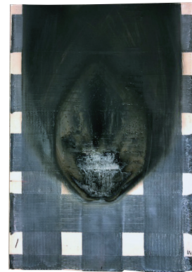
▲延焼性試験後の試験体
