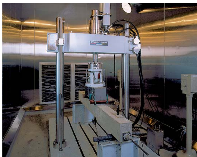
恒温恒湿室内に設置された200kN構造物疲労試験機
