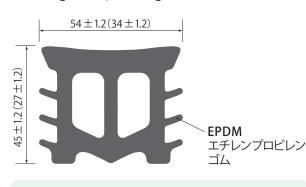
● OK-30は、コンクリート二次製品等で目地の直線性が 確保されている場合や、コンクリート側壁が薄い場合 に適用します。
