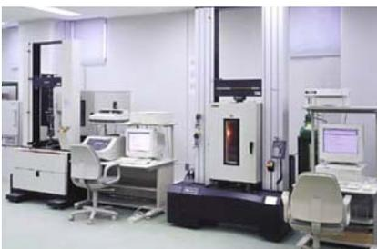
恒温槽付き万能試験機（50kN、150kN）
