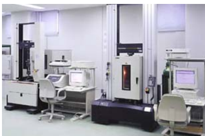
恒温槽付き万能試験機（50kN、150kN）
